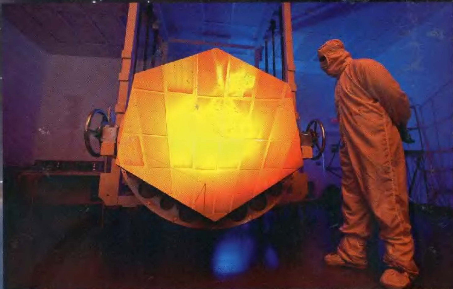
Сегмент зеркала телескопа «Джеймс Уэбб», покрытый золотом.
